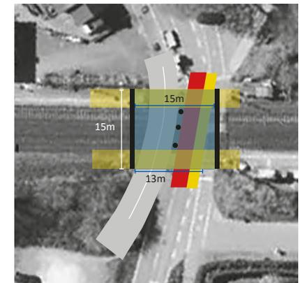
Abb. 11. 2-Tunnel-Lösung Brücke
